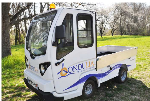
Quadricycle utilitaire électrique (7 kW) équipé d'un prolongateur d'autonomie à H2 (pile 1kW, réservoir 600g H2 /350 bar), réalisé par N-GHY (ALBHYON), INNOVEP, ONDULIA, immatriculé dans l'Ariège, présenté à POLLUTECH 2010
